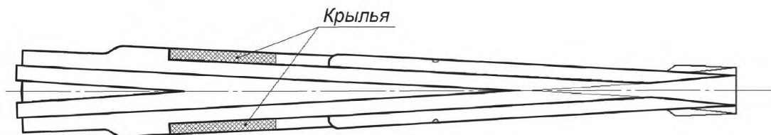
Рисунок 3.7 — Крылья литого сердечника сборной крестовины
